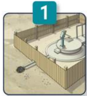
Poço escavado com bomba manual
