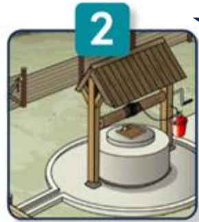
Poço escavado com guincho
