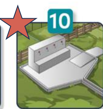
Распределение по трубопроводу: водопроводная колонка
